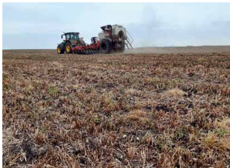
Obr. 4 Bezorebné přísevy secím strojem Bourgault FMS CD 872– záběr 6 m, s aplikací Explorer S10 pod patu
