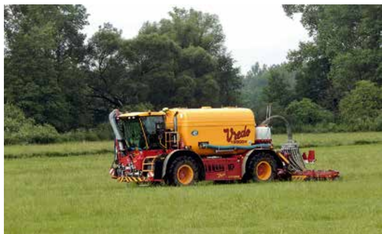
Přihnojování travního porostu diskovým aplikátorem VREDO
