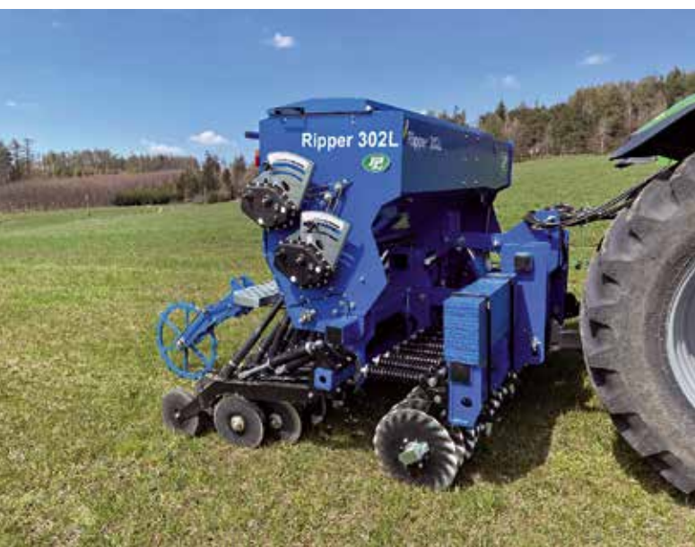
Obrázek č.1. Nový koncept secího stroje Ripper 302 s roztečí řádků 13,6 cm a dvoukomorovou výsevní skříní
