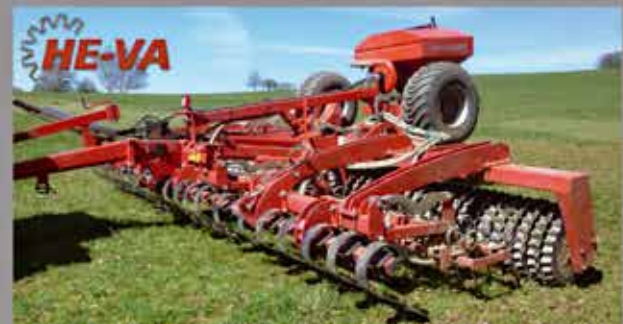
Luční válce s přisevem, efektivní rovnání po prasatech, vyčesání, přisev, podsev
