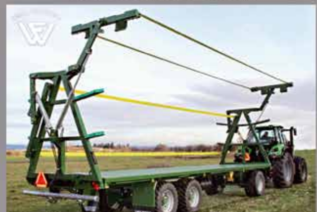
Přepravník balíků WESTERN s nosností až 24t a variabilním upínáním nákladu
