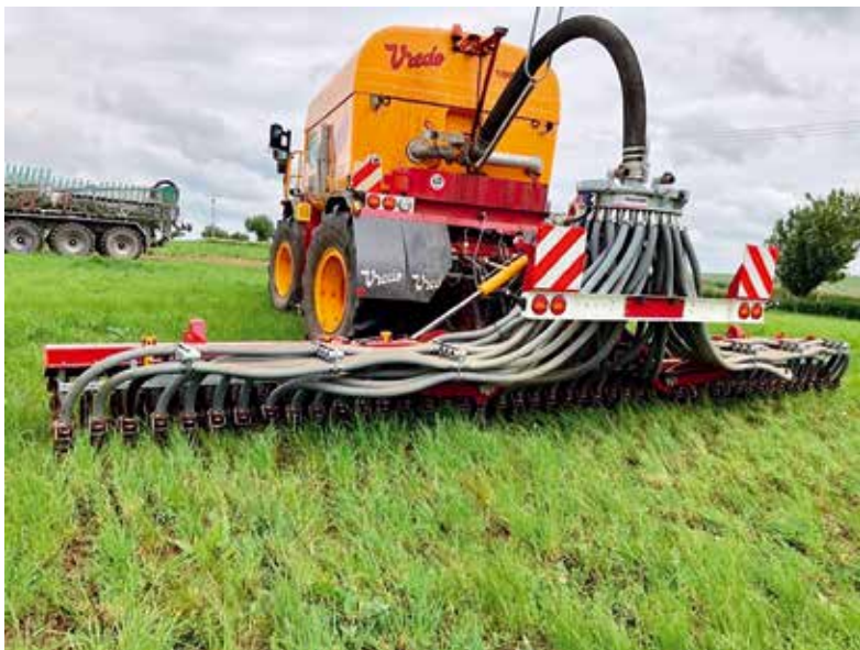
Obr. 2 Aplikace samojízdým aplikátorem vybaveným travním injektorem
