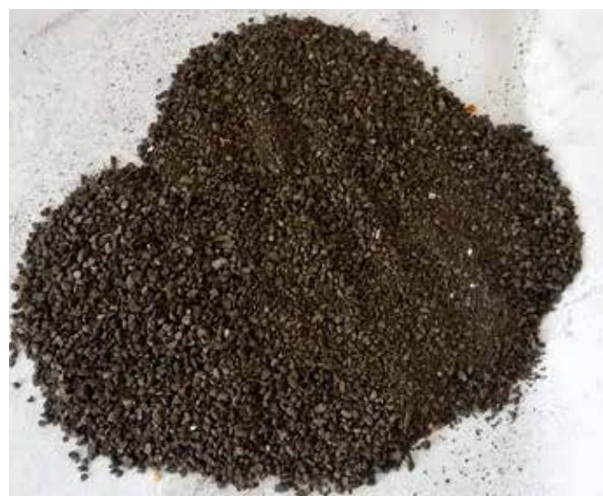
Obr. 2 Drvený alginit po úprave na frakciu 1 mm
