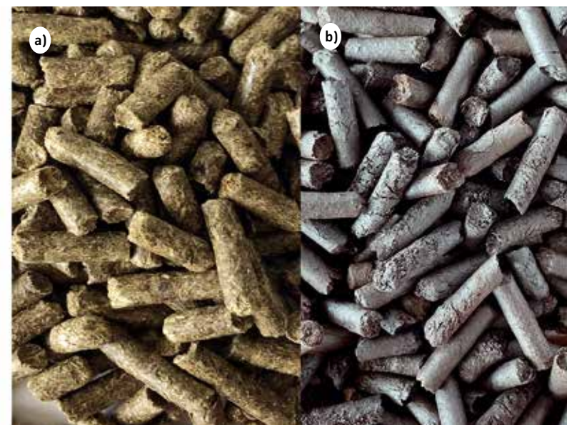
Obr. 1 Pelety z lučního sena. a) netorefikované b) torefikované
