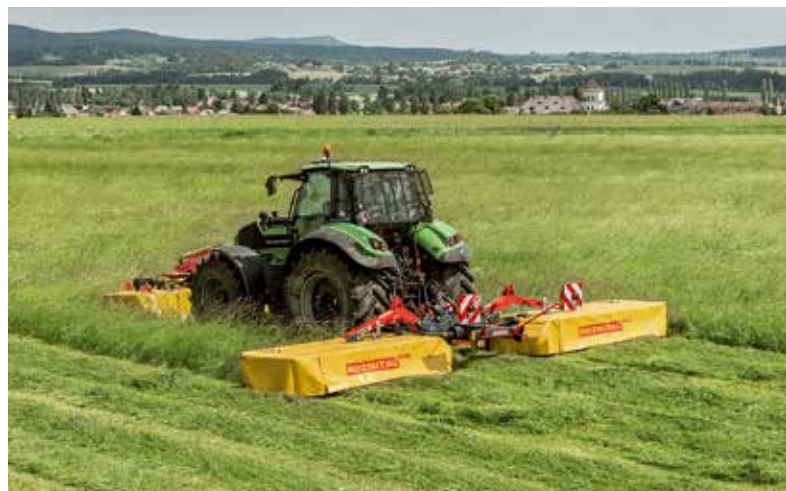
Čelní sekačka SC-301 se zadní nesenou žací kombinací SM-830 o pracovním záběru 8,2 m při práci
