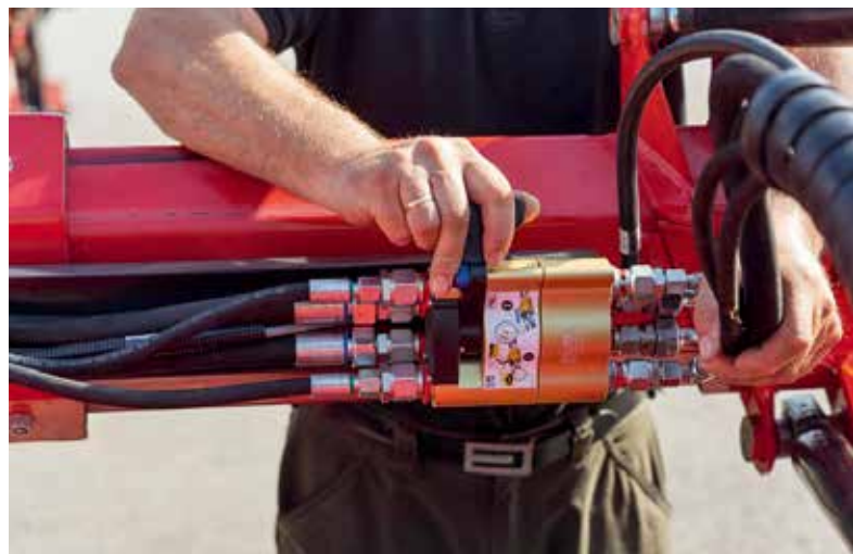
Sdružená rychlospojka pro rychlé odepnutí dopravníku BX
