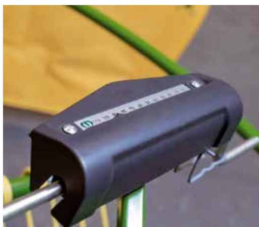
Je možné zvolit mezi mechanickým nastavením pracovní výšky (vlevo) nebo elektrickým přímo z kabiny (vpravo)
