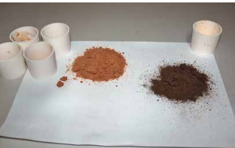
Stanovení obsahu organické hmoty žiháním při teplotě 550 °C po dobu 6 h. Vlevo vzorek půdy po žihání, vpravo vysušený vzorek připravený k žihání.
