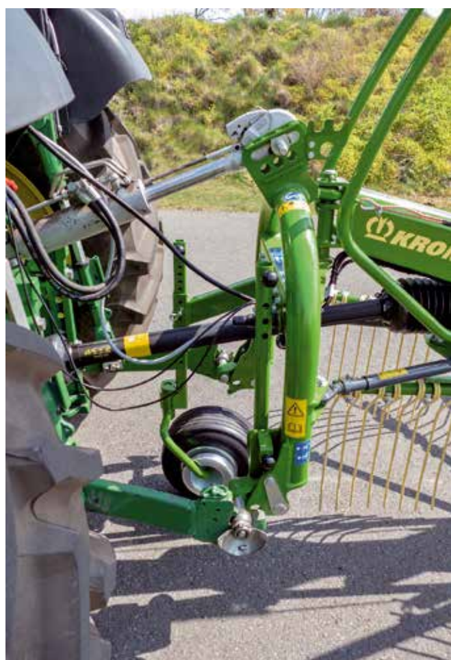
Čepy spodních ramen mají dvě pozice. Podle toho do jaké kategorie traktoru je shrnovač připojován.
