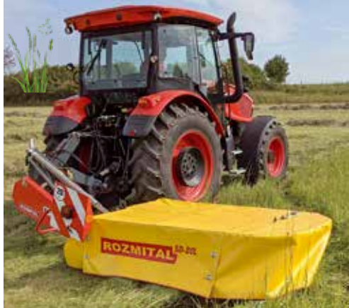
Odlehčená sekačka SD-20L s pracovním záběrem 2,03 m během testování
