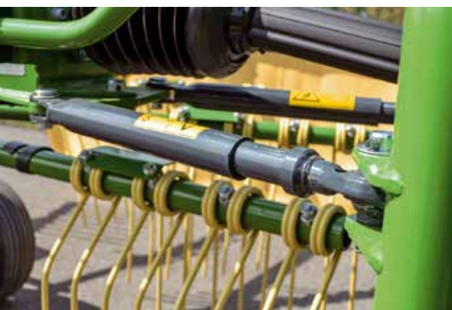
Nové tlumicí vzpěry shrnovače Swadro S
