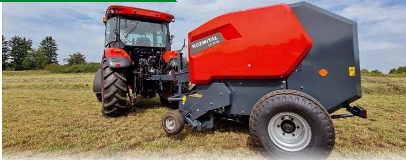
Válcový lis LB-V120 lisuje kulaté balíky o průměru a šířce 120 cm
