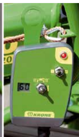
Je možné zvolit mezi mechanickým nastavením pracovní výšky (vlevo) nebo elektrickým přímo z kabiny (vpravo)
