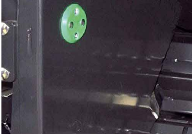
Vlhkostní čidlo v lisovací komoře
